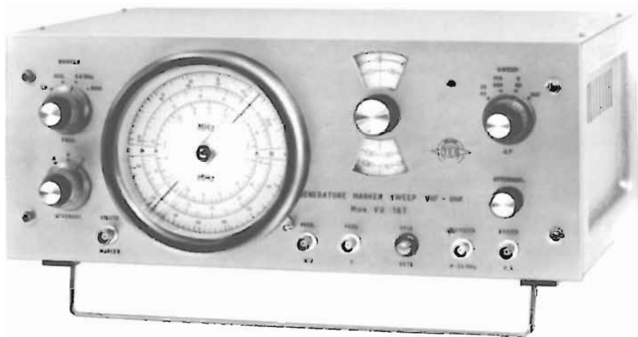
Fig. 16-C — Generatore di segnali video Mod. VU 167, prodotto dalla Technica Elettronica System. Questo strumento fornisce segnali di frequenza compresa tra 1 e 30 MHz in conversione e tra 35 ed 85 MHz in fondamentale, oltre che tra 170 e 260 MHz in fondamentale e tra 470 e 780 MHz in terza armonica, all'uscita della sezione « Sweep ». Il « Marker » è in grado di fornire tutte le frequenze di riferimento per l'osservazione delle curve di Alta e Media Frequenza. L'impedenza di uscita del segnale volubato è di 75 ohm.
