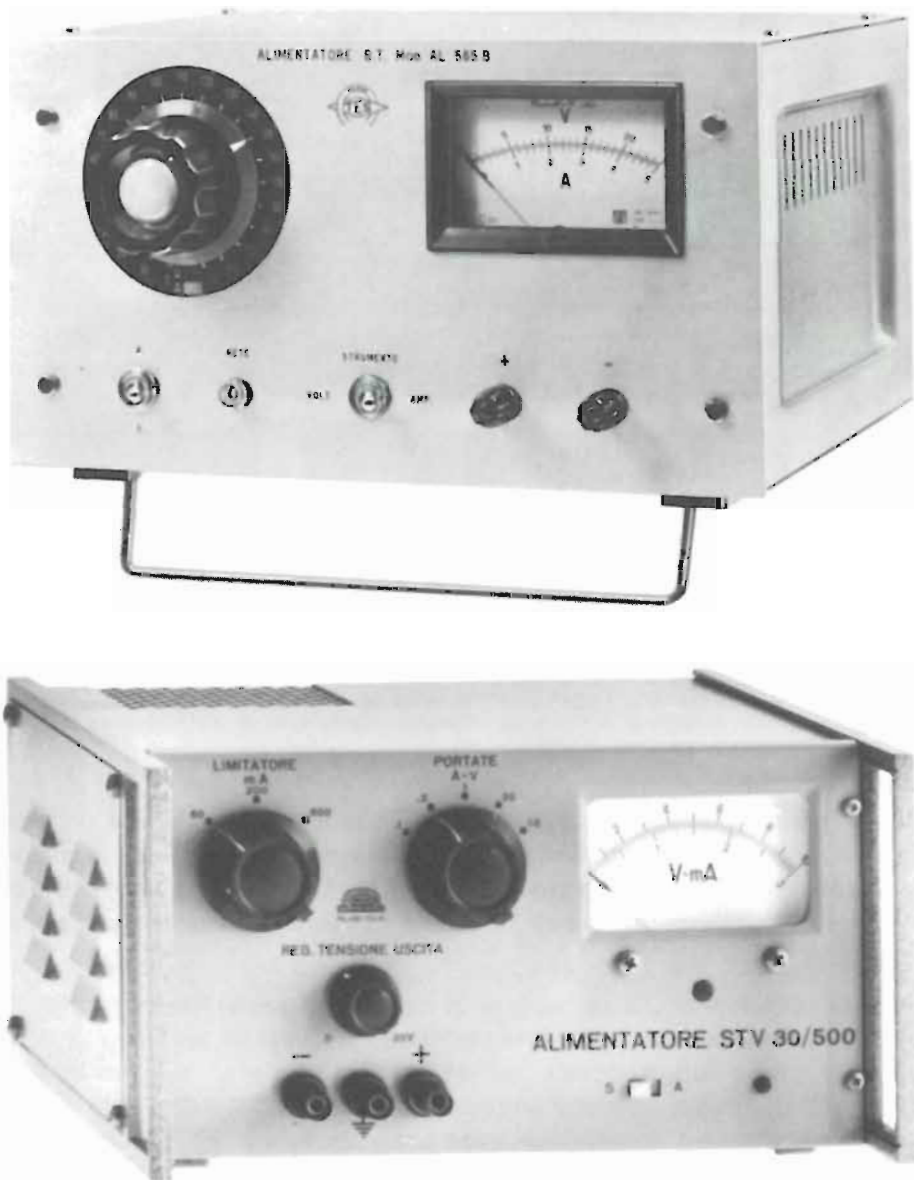
Fig. 11 — L'alimentatore stabilizzato da banco, di cui sono illustrati due esemplari, sostituisce in modo assai conveniente le batterie di accumulatori, per gli interventi sui ricevitori portatili. Il modello AL 565 B prodotto dalla Tecnica Elettronica System è regolabile con continuità da 0 a 25 volt, con una corrente massima di 5 ampère. Il modello STV 30/500, prodotto dalla Unaohm, fornisce invece una tensione regolabile da 0 a 30 volt, con una corrente massima di 600 milliamperè.
