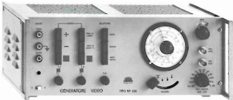
Fig. 20 — Fotografia dello strumento di cui alla figura 19. Con esso è possibile eseguire in breve tempo un'accurata verifica delle prestazioni e dello stato di funzionamento di ogni singolo settore di qualsiasi tipo di televisore.
